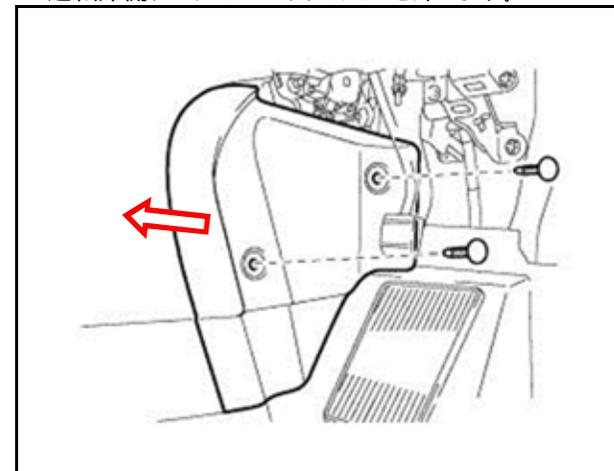
助手席側フロアカーペットカバーを外します。
