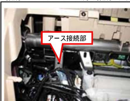
アースポイントがないため、この穴を利用して付属のボルト・ナットにてアース線を固定します。
