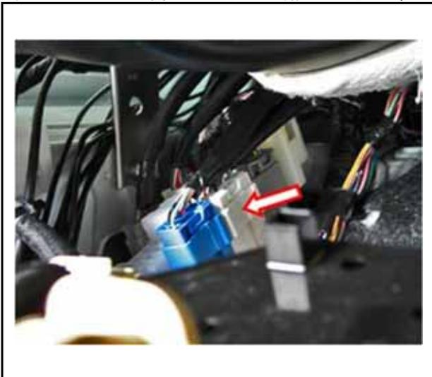
・メインボディECUの各カプラに接続ハーネスBの各配線をエレクトロタップで接続します。
