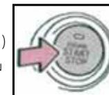
フットブレーキを踏まずにエンジンスイッチを2回押します。(IG ON)
