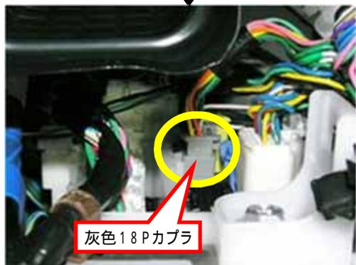
エアコンダクトの右下付近にある灰色18Pカプラに接続ハーネスの18Pカプラを割り込み接続します。
