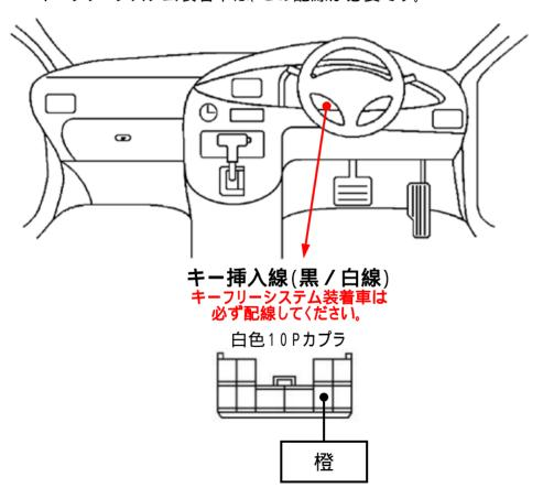
イモビアダプターに付属のコントロールハーネスを 下図のように加工し、黒/白線を表記のキー挿入線 へ接続してください。
