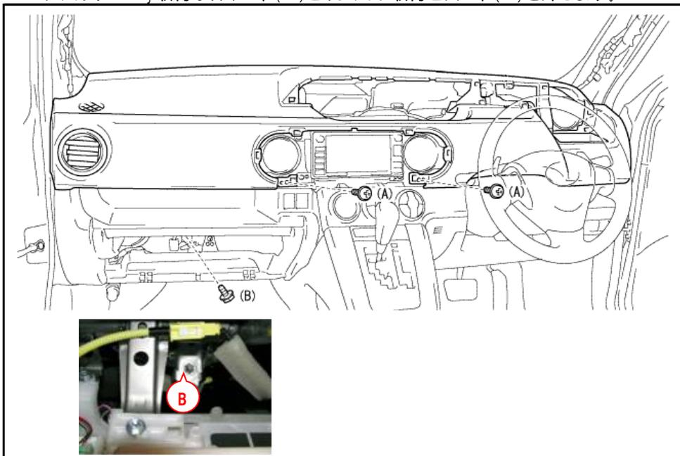
インストルメントパネルを下図のように助手席側のみ持ち上げ、接続ハーネスAの18Pカプラと接続ハーネスBの25Pカプラを割り込み接続します。
