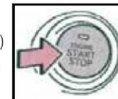
フットブレーキを踏まずにエンジンスイッチを2回押します。(IG ON)
