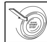
フットブレーキを踏まずにエンジンスイッチを2回押します。(IG ON)
