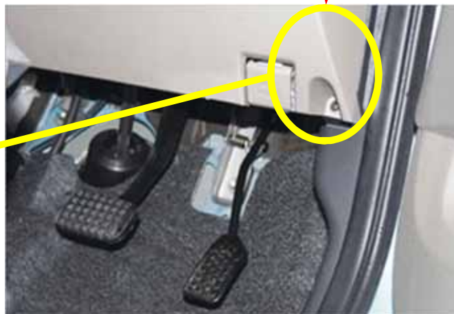
イモビアダプター「IM81」25Pカプラ 割り込み接続先
