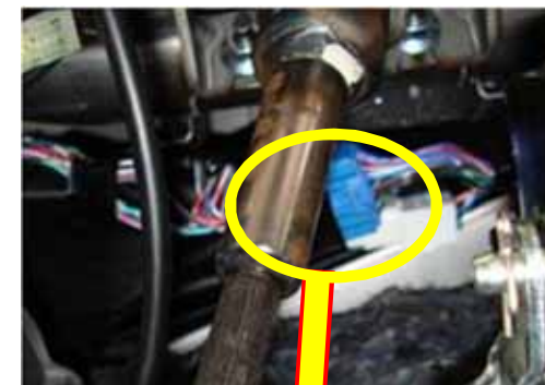
イモビアダプター「IM83」22Pカブラ割り込み接続先 (ステアリングシャフト奥の青色22Pカブラ)
