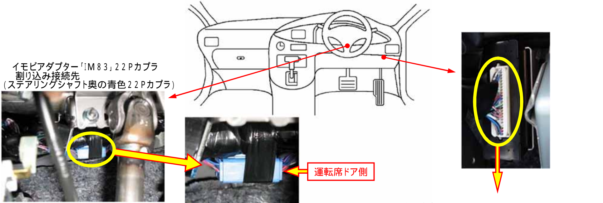
イモビアダプター「IM83」茶色線接続先 (キーフリーコントロールユニットの白色40Pカブラ)
