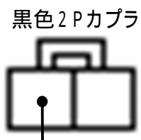
フットブレーキ配線(白色線)
