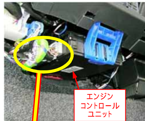
専用ハーネス「T804D」 橙線の接続先(STT線) 必ず配線してください。
