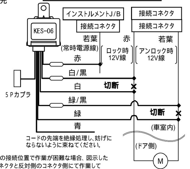
コードの先端を絶縁処理し、妨げにならないように束ねてください。
