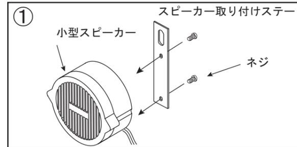
○スピーカー取り付けステーと小型スピーカーをネジでしっかりと締めて下さい。（2箇所）
