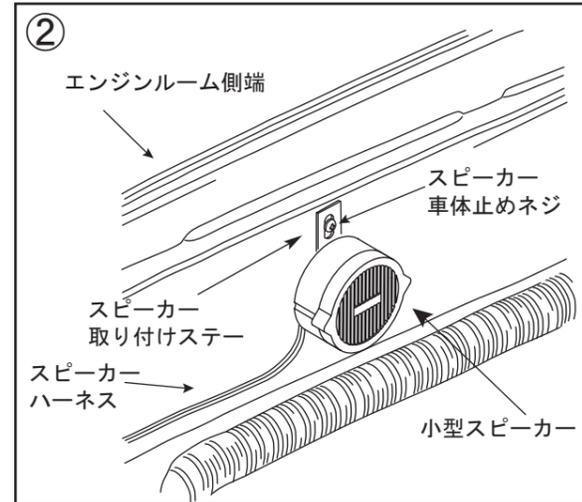
○スピーカー取り付けステーと車体をスピーカー車体止めネジでしっかりと締めて下さい。
