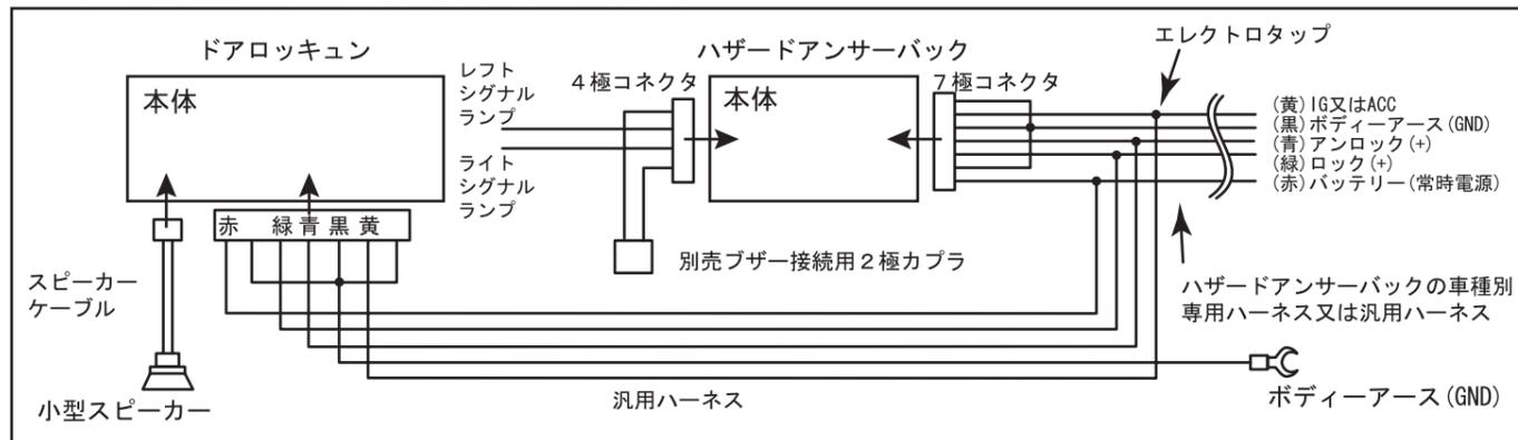
上図のように、ドアロックユニット本体からの汎用ハーネスをハザードアンサーバック本体からのハーネスにエレクトロタップを使用してを接続します。
