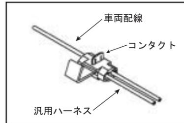
1, 接続する車両配線がビニールチューブ (ビニールテープ) で覆われている場合は、適量をカットして下さい。
