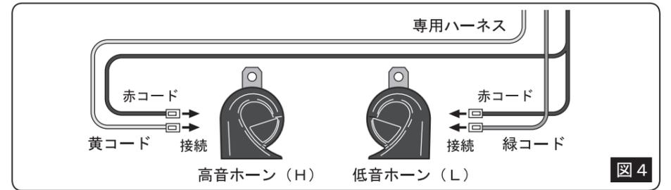
ホーンの高音、低音を間違えて接続しないよう注意してください。高音、低音を間違えると正常に鳴りません。また、端子の接続が不確実だと接触不良や端子抜けの原因となります。
