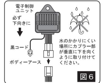
②リード線の引き出し口が下を向くように取り付けてください。（図6参照）
