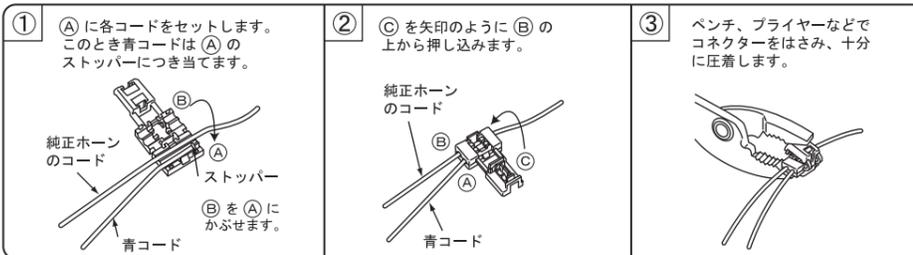
純正ホーンから外した配線の先端やコネクター部はテーピングし、他の部分と絶縁してください。絶縁処理が不十分な場合、被水等により誤動作する恐れがあります。
