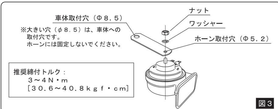
ホーンのステーは、必ず本品付属の専用ステーをご使用ください。また、専用ステーは絶対に折り曲げて使用しないでください。共振の発生や強度不足により、性能の低下、故障、折損の原因となります。
