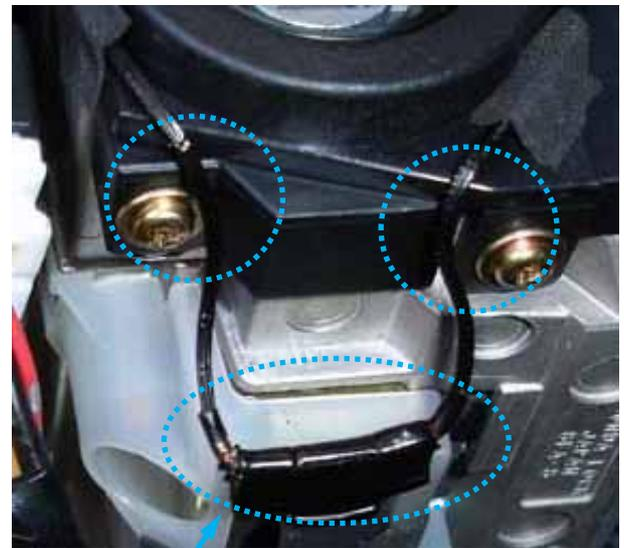
コイルアンテナは極力車両側のアンテナ部に近づけた状態で貼り付けます。
