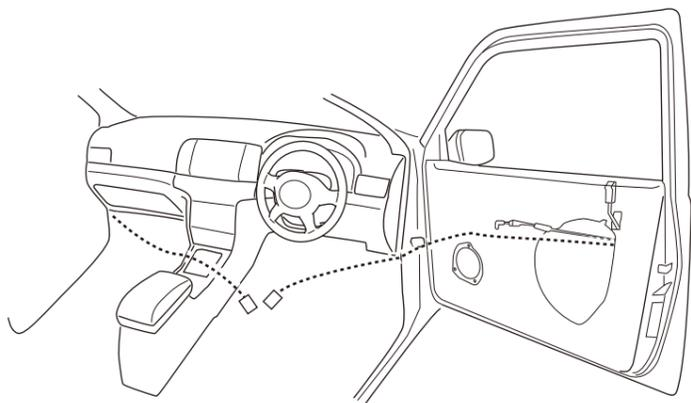
**注意** 動作確認の際に十分な感度が得られない場合、マイクセンサーの取り付け位置を変えられるよう、ドアの内張りは動作確認完了まで元に戻さないでください。
