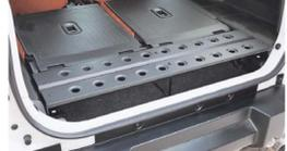
る。ジムニーJ B64・ジムニーシエラJ B74専用で全グレードに対応。スチール製ながら、曲げ加工とパーリング加工で強度を持たせながら、軽量化も施した。中央下部にはスタンドが装着され、お好みで荷物を置いても、下部スペースを有効活用できる。
